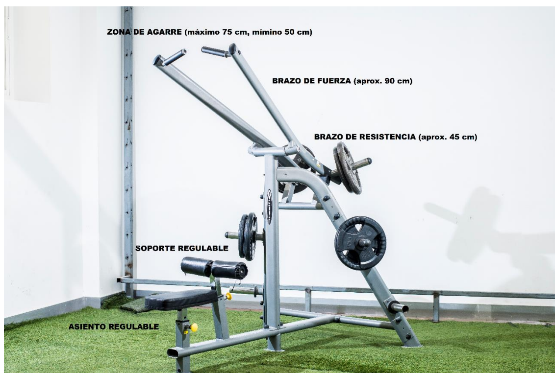
Fig. 2. Máquina para la evaluación de la fuerza y la resistencia en el movimiento de tracción en posición sentado (Steelflex PLLA, Taiwan)
